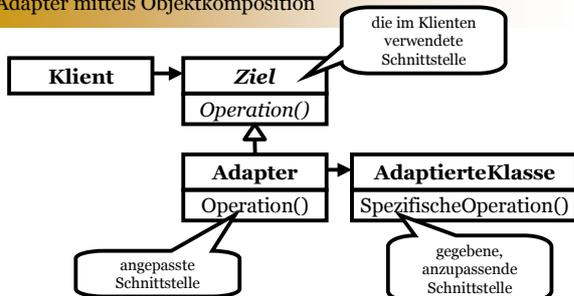
→ Komplexität des Adapters hängt von der Ähnlichkeit der Zielschnittstelle mit der Schnittstelle der anzupassenden Klasse ab
